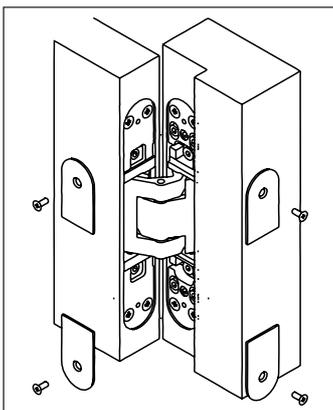
Die Abdeckplättchen mit beiliegenden, selbstschneidenden Schrauben auf Rahmen- und Flügelteil verschrauben.
