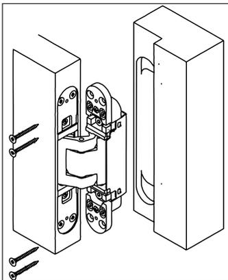
Bandrahmenteil je nach Zargentyp befestigen. Ggf. die oberen Klemmschrauben der Höhenverstellung pro Band leicht lösen.
