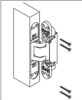
Die Fräsungen vornehmen, Fräser 24 mm Ø, Anlauftring 30 mm Ø, Bandflügelteil (gekennzeichnet mit "Door") mit Holzschrauben 5 mm Ø verschrauben.
